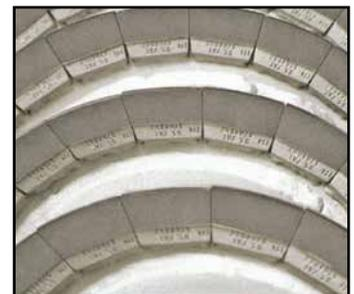
Due versioni di coclea: rivestita in carburi di tungsteno saldobrasato oppure con placchette in carburo di tungsteno
