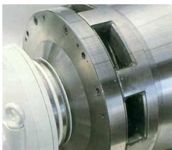
Protezione contro l'usura in uscita solido impiegando boccole di carburi di tungsteno sinterizzato intercambiabili.
