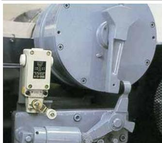
Differenziale con doppio motore (variazione della velocità della coclea opzionale) oppure a braccetto fisso con sgancio.
